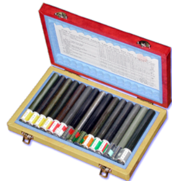
図1 火花試験標準片グループ K15 鋼種の外観
