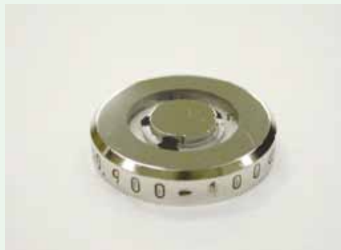
ナノインデンテーション用単結晶製超微小硬さ基準片試作品 \phi 25mm (W, 硬さ約400HV)
